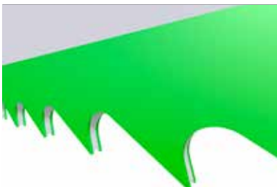
Többélű vágóél Szétदारaboltabb forgács
